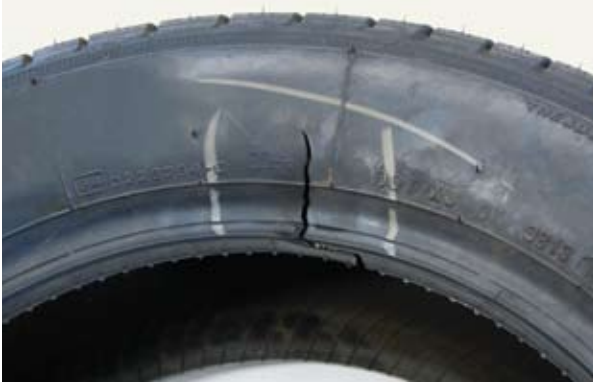
Afb. 15: hielkern gebroken door te hoge spanning tijdens montage
