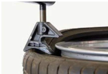
Afb. 13: hulparm of klem die de hiel in het diepbed houdt tijdens montage
