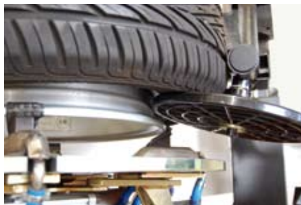
Afb. 12: hulparm om de onderste hiel los te maken
