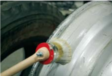
Afb. 13: breng montagepasta aan op het velgbed
