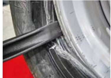
Afb. 10: methode 2: ruimte maken voor hiellichter
