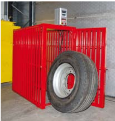
Afb. 21: bandenkooi met automatische pompklok
