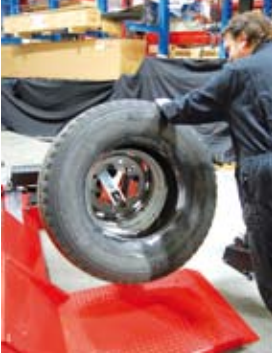
Afb. 15: licht de eerste hiel over het wiel
