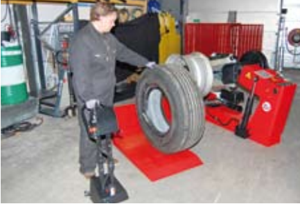
Afb. 11: tweede hiel verwijderd
