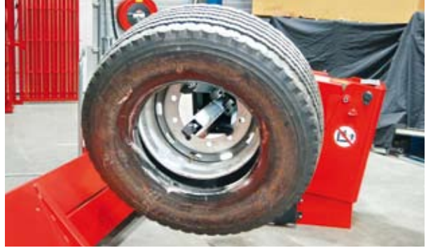
Afb. 16: de band geplaatst over de eerste hiel
