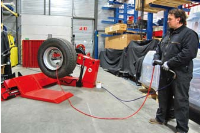
Afb. 2: sta bij het oppompen in de richting van het loopvlak
