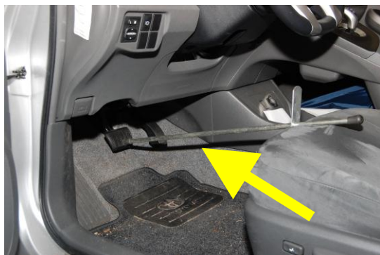
Afbeelding 34. Een remmenknecht is snel en nauwkeurig
