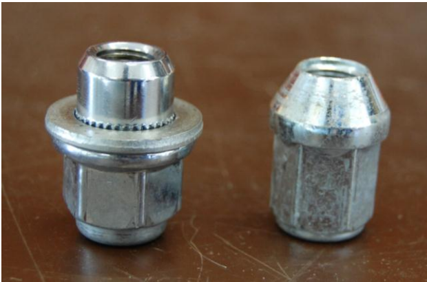
Afbeelding 30. Cilindrische en een conische moer
