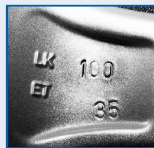
Afbeelding 7. Steekcirkeldiameter en ET-waarde
