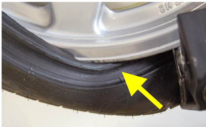
Afbeelding 26. Hoge spanning bij montage
